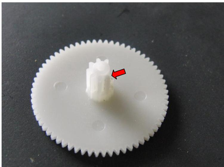
一見して、破損していないようでも、外側の歯が、破損しているときがある。
