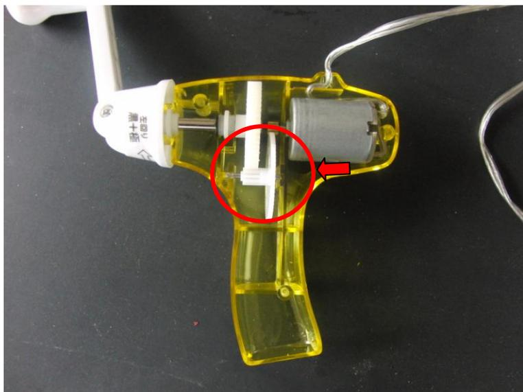
赤の丸で囲んだギアの歯が、破損している。
