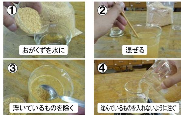
図5 前処理の手順(①→②→③→④→加熱開始)
