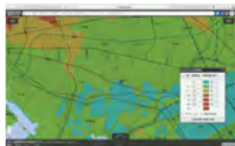
▲地理院地図の機能を使って、ニ崎市南西部で標高5mごとの段彩図を作成した。(出典：国土地理院 地理院地図)
