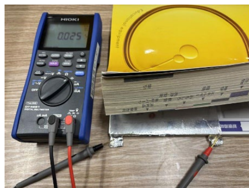
図1 電気容量測定の様子
