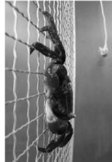
図 4：甲殻類型ロボット 1 号機の脚の動作
