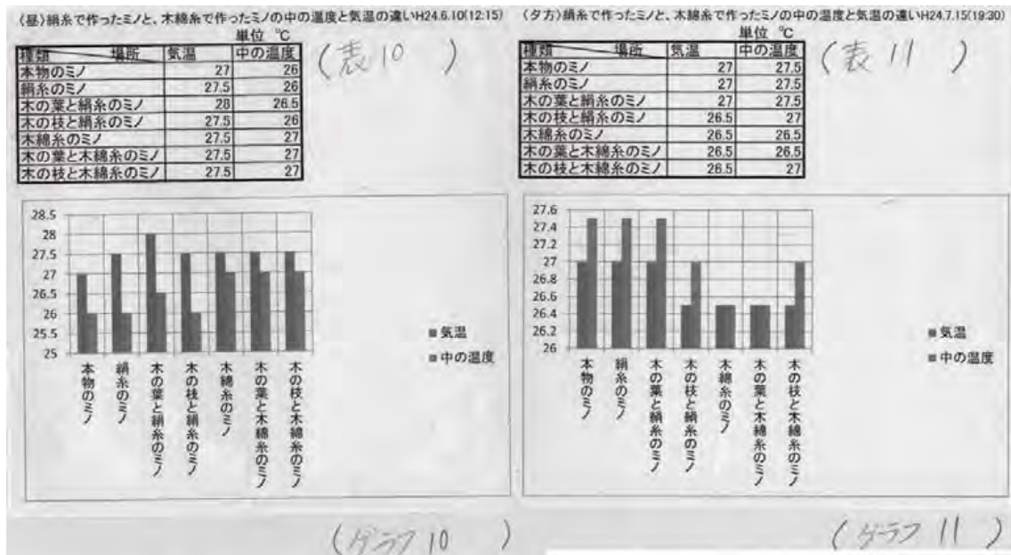
図5 材料によるミノの中の温度の違い
